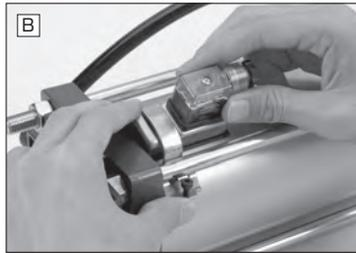
●調整後のスイッチ固定は、セットボルトを締付けてください。
